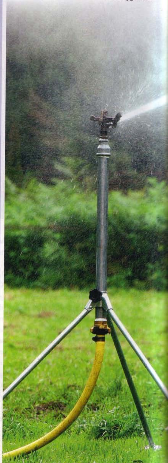
LINKS: Klepelsproeier. De kop draait rond doordat de waterkracht op een klepel drukt.
