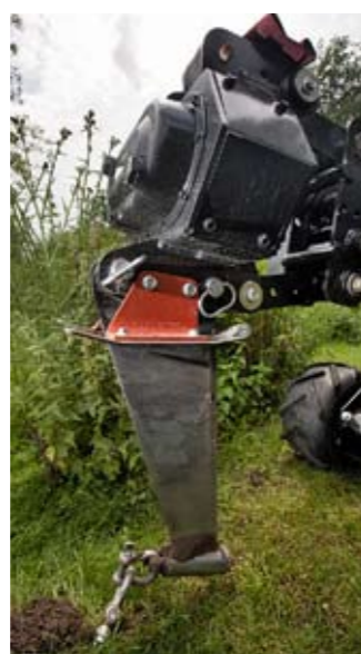
Onderaan het mes van de kabelploeg zit een kogel waaraan de leiding wordt gekoppeld.
