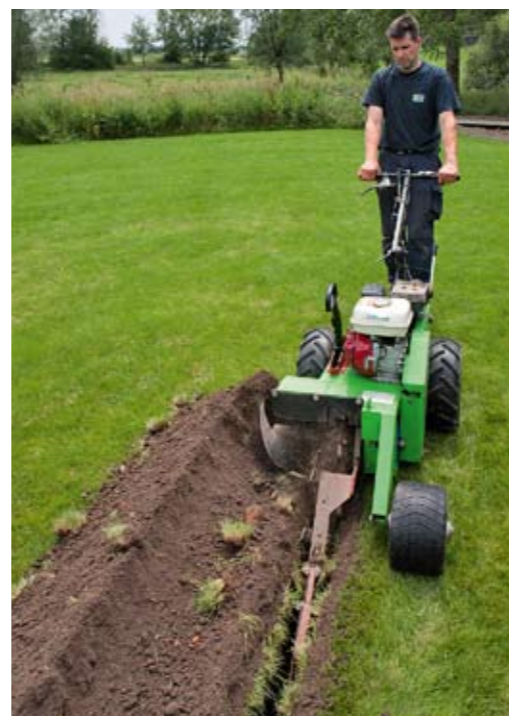
De sleuvenfrees laat meer sporen achter dan de kabelploeg.
